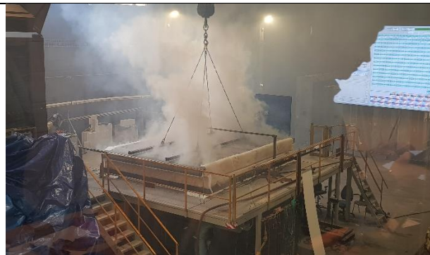
Fig. 2: Branntest av 3-doble gitterdragere med vertikallast
